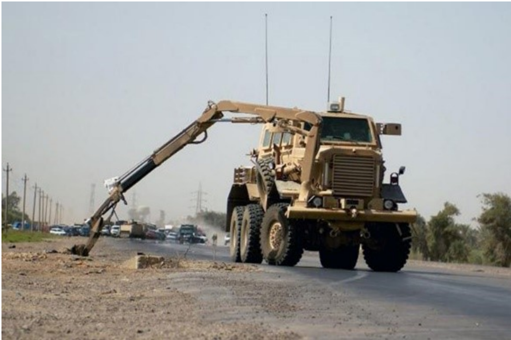
Force Protection Buffalo IED y Mine Clearance MRAP eliminan un dispositivo explosivo mediante el uso de su garra hidráulica articulada.
